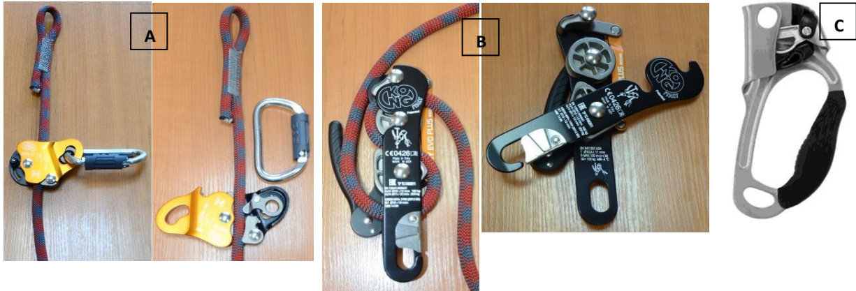
Rys. 22. Przykłady budowy urządzeń do asekuracji, zjazdu i podchodzenia.
